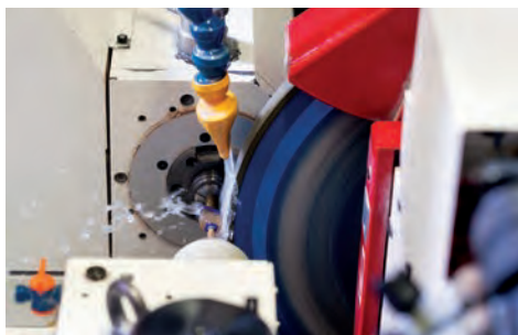
Einblick in die CNC-gesteuerte Bearbeitung von Edelsteinen
